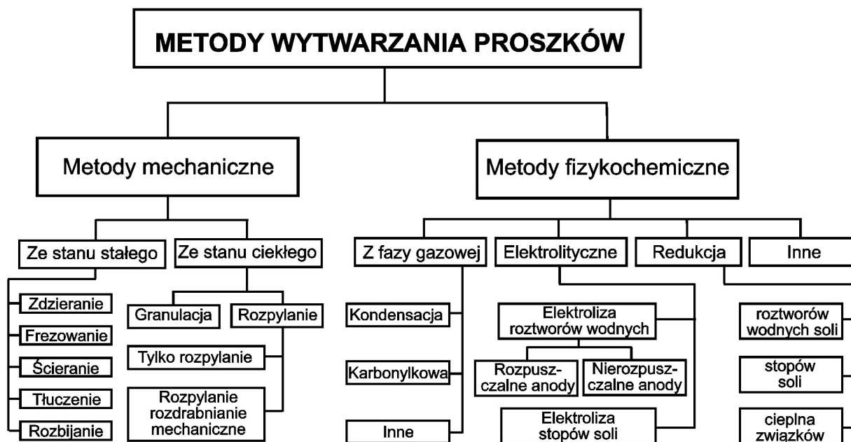
Rys. 11.1. Metody wytwarzania proszków, wg A. Ciasia, H. Frydrych, T. Pieczonki
