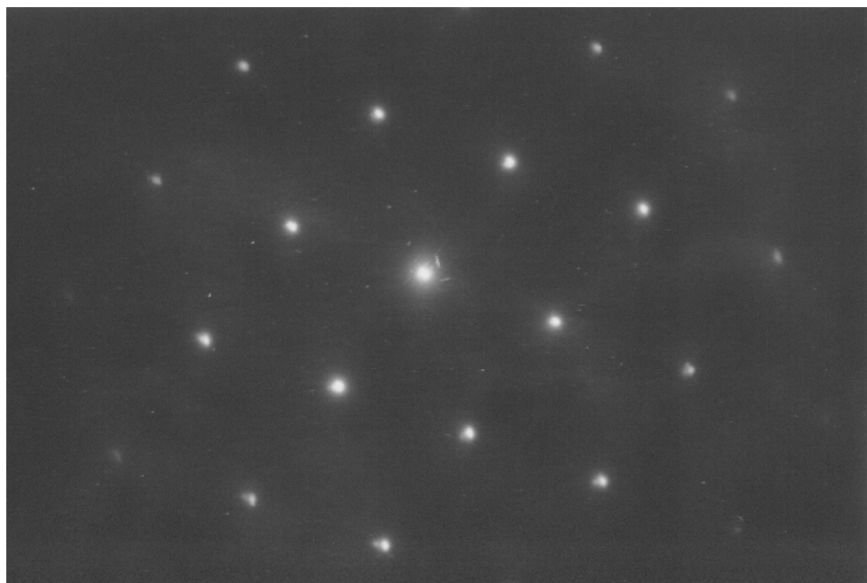
Rys. 4.12. Dyfraktogram elektronowy z monokryształu stali austenitycznej. Jasne punkty odpowiadają poszczególnym płaszczyznom krystalograficznym
