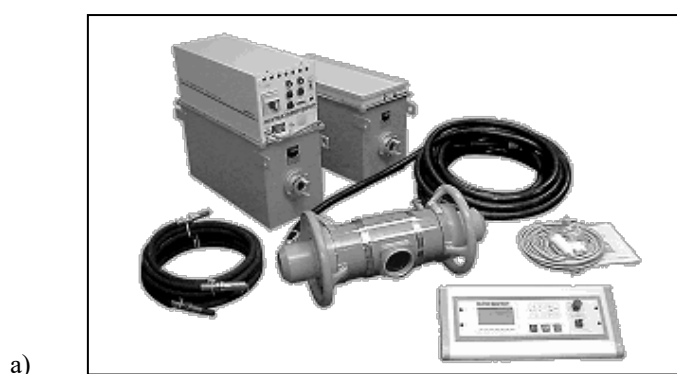
Rys. 2.7. Kołpakowy, przenośny aparat do badań rentgenowskich z lampą jednobiegunową. a) widok ogólny, b) schemat blokowy aparatu rentgenowskiego gdzie: 1- urządzenie sterujące, 2-układ zasilania, 3-generator wysokiego napięcia, 4-kable wysokiego napięcia, 5-lampa rentgenowska, 6-wiązka promieniowania, 7-przewody łączące lampę z układem chłodzenia, 8-układ chłodzenia wodą.
